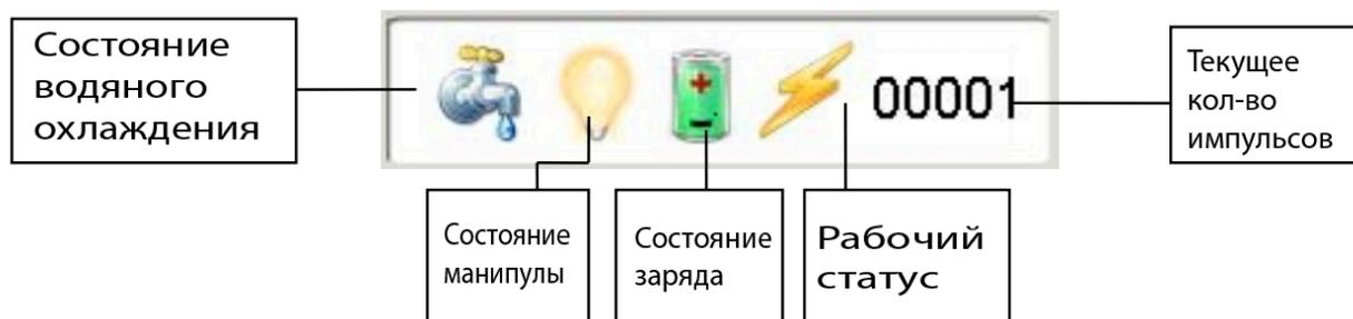
Индикация отображения состояния системы охлаждения, температуры воды
