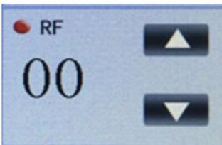
– Настройка мощности RF: В процессе настройки в окне отображения энергии будет отображаться текущее значение мощности. Диапазон настройки радиочастоты от 1 до 20, эту настройку можно выполнить непосредственно во время процедуры, регулируя с помощью кнопок « $\uparrow$ » или « $\downarrow$ » кнопка для увеличения, « $\downarrow$ » кнопка для уменьшения;
